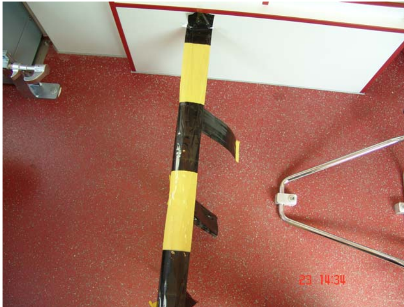
Abb. 1a) Strömungsverlauf oberhalb des Bodens, nach rechts in Richtung Ansaugung der Klimaanlage
