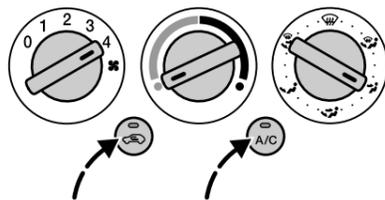
Das Gebläse auf Stufe **4**, Temperaturregler ganz auf kühl und Luftverteilungsregler auf Position
